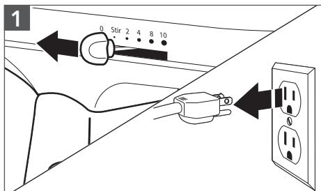
Coloque la batidora con base en la posición de apagado (0) y desenchufe.
