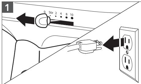
Déplacer le bouton d'alimentation sur arrêt (0), puis débrancher le batteur sur socle.
