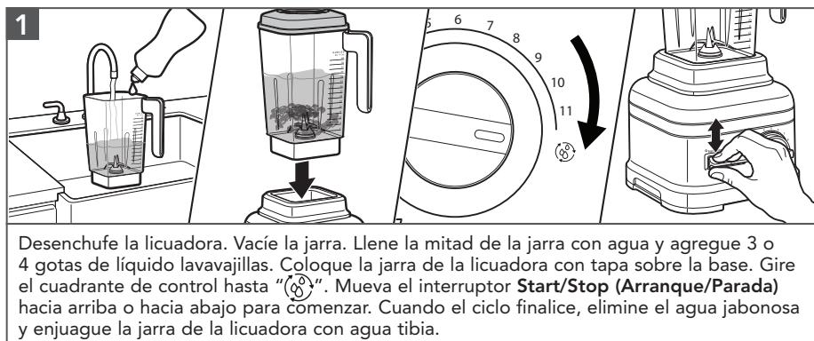
Desenchufe la licuadora. Vacíe la jarra. Llene la mitad de la jarra con agua y agregue 3 o 4 gotas de líquido lavavajillas. Coloque la jarra de la licuadora con tapa sobre la base. Gire el cuadrante de control hasta "(8)". Mueva el interruptor **Start/Stop (Arranque/Parada)** hacia arriba o hacia abajo para comenzar. Cuando el ciclo finalice, elimine el agua jabonosa y enjuague la jarra de la licuadora con agua tibia.
