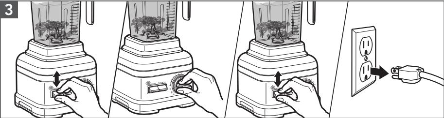
Placer l'interrupteur **Start/Stop** (marche/arrêt) vers le haut ou le bas pour mettre en marche. Faire tourner le bouton de commande à la vitesse désirée. Consulter le « Guide de contrôle de la vitesse » pour plus de détails. Une fois terminé, placer l'interrupteur **Start/Stop** (marche/arrêt) vers le haut ou le bas pour arrêter. Débrancher le mélangeur avant d'enlever le récipient du mélangeur.
