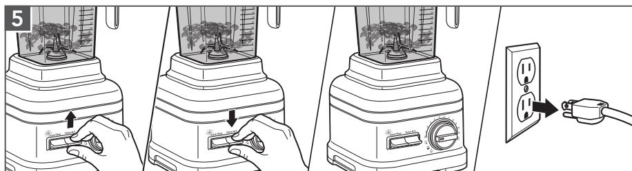
**Uso de la función Pulse (Pulsador):** Mantenga presionado el interruptor **Pulse H/L (Pulsador alto/bajo)** hacia arriba para pulsar más rápido o hacia abajo para pulsar más despacio. Suelte el interruptor **Pulse H/L (Pulsador alto/bajo)** para detener el funcionamiento. Desenchufe la licuadora antes de quitar la jarra.
