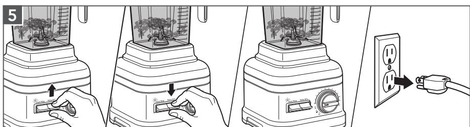
**Utilisation de la fonction Pulse (impulsion) :** Maintenir enfoncé l'interrupteur **Pulse H/L** (impulsion É/B) vers le haut pour des impulsions rapides ou vers le bas pour des impulsions lentes. Relâcher l'interrupteur **Pulse H/L** (impulsion É/B) pour arrêter. Débrancher le mélangeur avant d'enlever le récipient du mélangeur.
