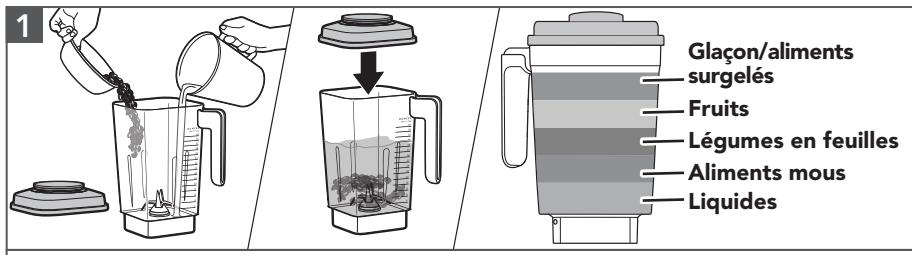
Introduire les articles à mélanger dans le récipient. Fixer le couvercle avec bouchon à mesurer les ingrédients.
