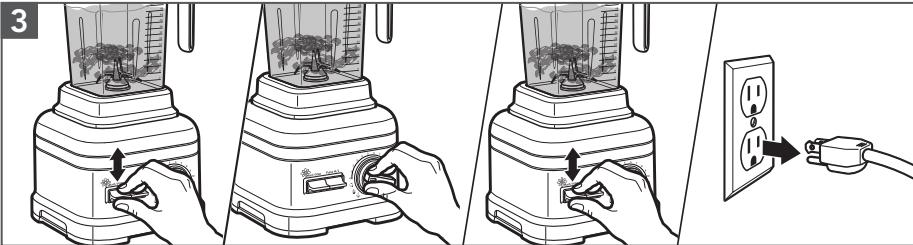
Mueva el interruptor **Start/Stop (Arranque/Parada)** hacia arriba o hacia abajo para comenzar. Gire el cuadrante de control hasta la velocidad deseada. Para obtener más información, vea la "Guía de funciones de la licuadora". Después de que finalice, mueva el interruptor **Start/Stop (Arranque/Parada)** hacia arriba o hacia abajo para detener el funcionamiento. Desenchufe la licuadora antes de quitar la jarra.
