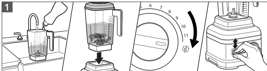
Débrancher le mélangeur. Vider le récipient du mélangeur. Remplir le récipient à moitié d'eau et ajouter 3 à 4 gouttes de savon à vaisselle liquide. Placer le récipient avec le couvercle sur le socle du mélangeur.
