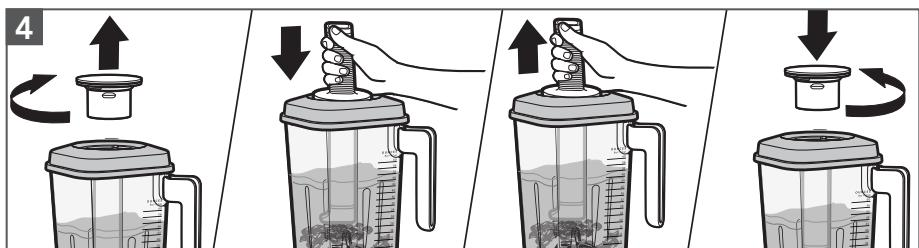
**Utiliser le pousoir :** Ne retirer que le bouchon du couvercle. Remuer le contenu ou appuyer dessus pour le diriger vers la lame. Une fois terminé, replacer le bouchon avant de poursuivre l'utilisation.
