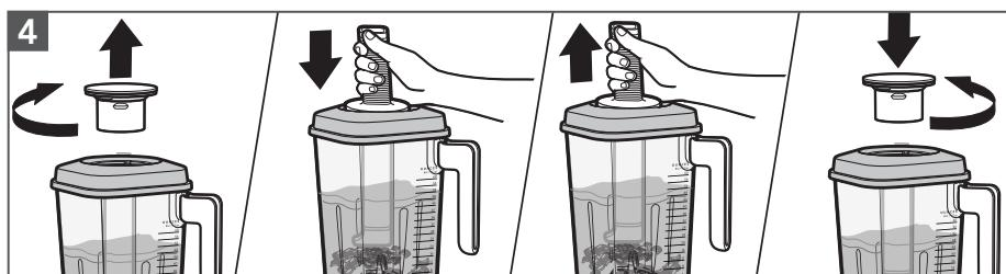
**Uso del apisonador:** Quite solamente la taza medidora de ingredientes. Revuelva o presione el contenido hacia la cuchilla. Cuando finalice, vuelva a colocar la tapa antes de continuar con el licuado.
