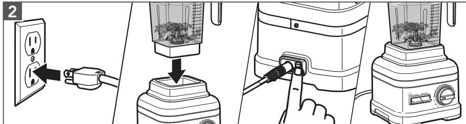
Brancher le mélangeur sur une prise de courant à 3 alvéoles, reliée à la terre. Placer le récipient sur le socle. Placer l'interrupteur d'alimentation à la position de marche (I). Le témoin lumineux d'état clignotera, ce qui indique que le mélangeur est en mode attente et prêt.
