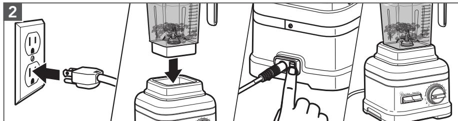
Enchufe la licuadora en un tomacorriente de 3 terminales con descarga a tierra. Coloque la jarra de la licuadora sobre la base. Mueva el interruptor de encendido hacia la posición de encendido (!). La luz indicadora de estado se encenderá de manera intermitente, lo que indica que la licuadora está en modo de espera y lista.
