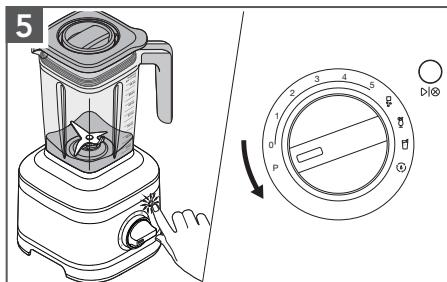
**Mode Pulsion :** Appuyer sur (▷|∅). Tourner et maintenir le bouton de commande de (O) à (P) par intervalle de temps. Après avoir terminé, relâcher le bouton pour arrêter.
