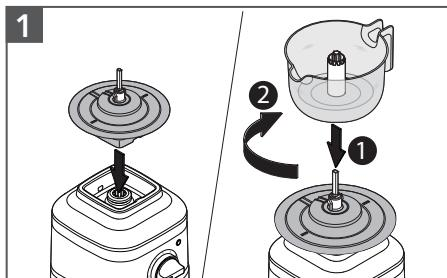
Coloque el conjunto de engranajes en la base. Coloque el recipiente para jugo en el conjunto de engranajes y gírelo en sentido horario para que se trabe en su lugar.
