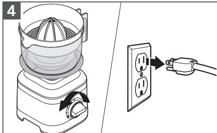
Appuyez sur le bouton (▷ ⊗) pour arrêter le mélangeur. Tourner le bouton de commande à (0). Débrancher le mélangeur.
