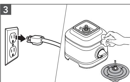
Desenchufe antes de limpiar. Limpie la base, el cable de alimentación y el conjunto de engranajes de la prensa para cítricos con un paño humedecido con agua tibia y luego seque todo con un paño suave.
