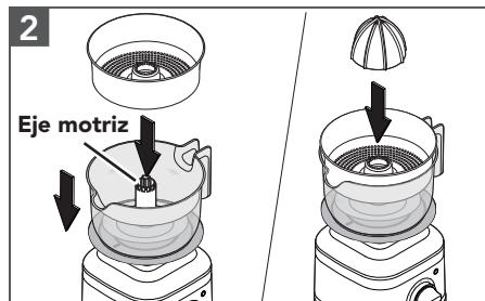
Coloque la canasta para pulpa y luego el exprimidor en el recipiente para jugo, colóquelo alineado con el eje motriz.
