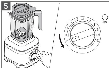
**Modo de Pulsador:** Presione ( $\square|\otimes$ ). Gire y sostenga el cuadrante de control desde (0) hasta (P) según el intervalo de tiempo deseado. Cuando termine, suelte el cuadrante de control para detener la licuadora.
