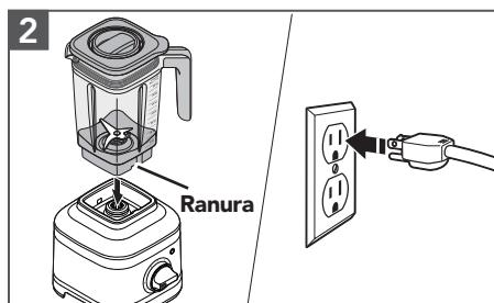
Coloque y alinee la jarra con la ranura para que quede dentro de la base de la jarra; la manija de la jarra debe quedar mirando hacia el cuadrante de control. Enchufe la licuadora en un tomacorriente de 3 terminales con descarga a tierra.
