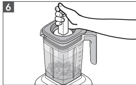
**Pousoir :** Retirer le bouchon central de couvercle seulement. Remuer le contenu ou appuyer dessus pour le diriger vers la lame. Puis, remettre en place le bouchon central de couvercle avant de recommencer à mélanger.
