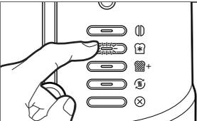
Presione (⊛); encenderá la luz indicadora para descongelar. La tostada saltará automáticamente al final del ciclo y el tostador se apagará.
