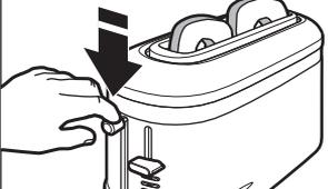
Con la palanca de control de tostado ajustada en el nivel deseado, presiónela hacia abajo para comenzar el ciclo de tostado.
