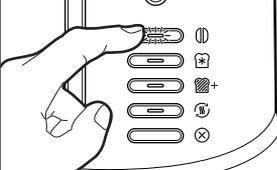
Presione (⓪); encenderá la luz indicadora para rosca. La(s) rosca(s) saltará(n) automáticamente al final del ciclo y el tostador se apagará.
